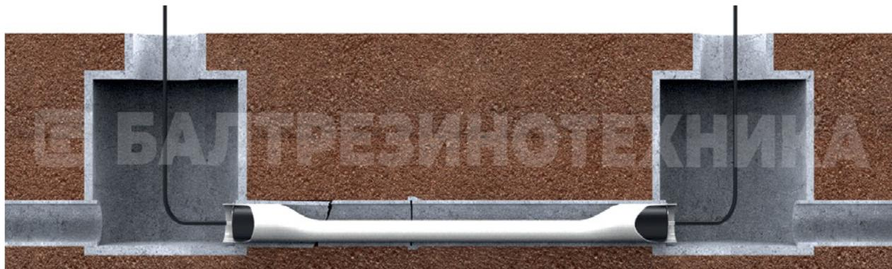
6. Труба расправляется и плотно прижимается к ремонтируемой трубе.
